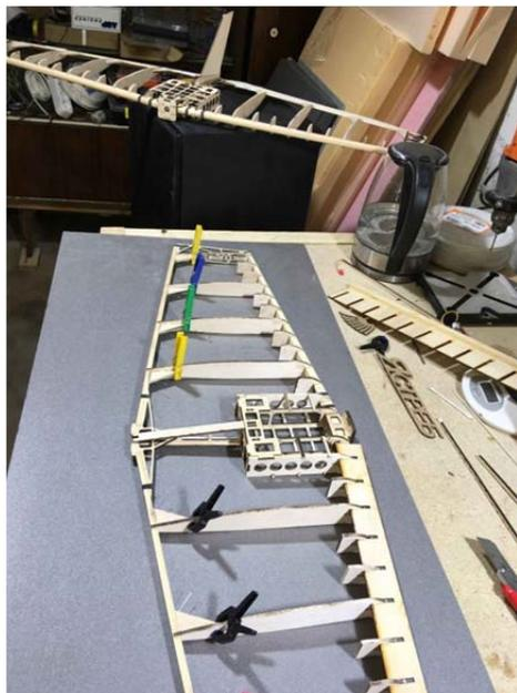
Вклеиваем поперечины на центральной части и бобышки-ограничители посадки лючка.
