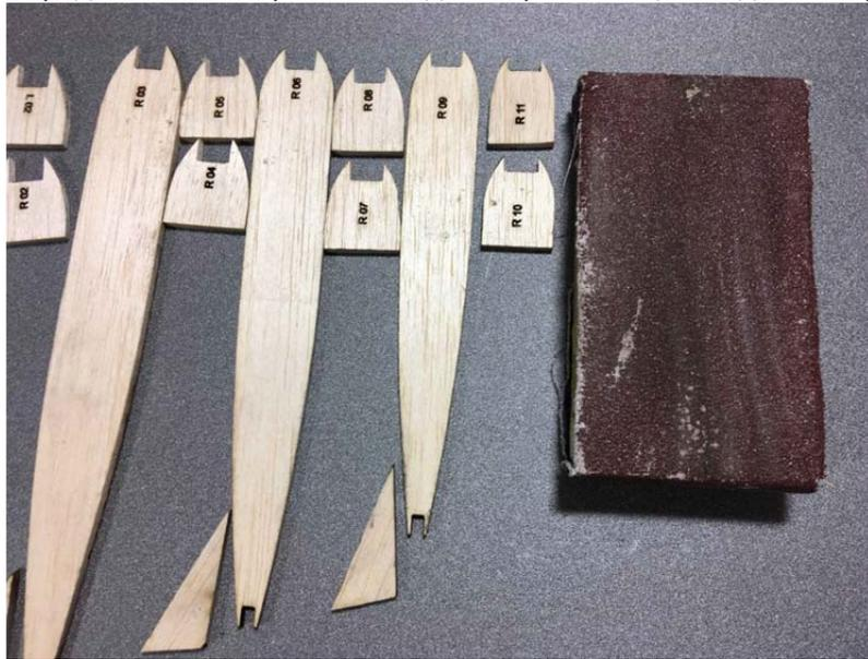
Скругляем углы передней кромки.
