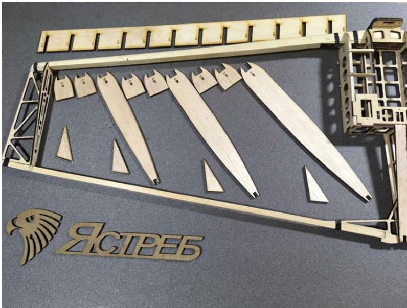
Устанавливаем гребенку и клеим детали согласно нумерации. Вклеиваем уголки.
