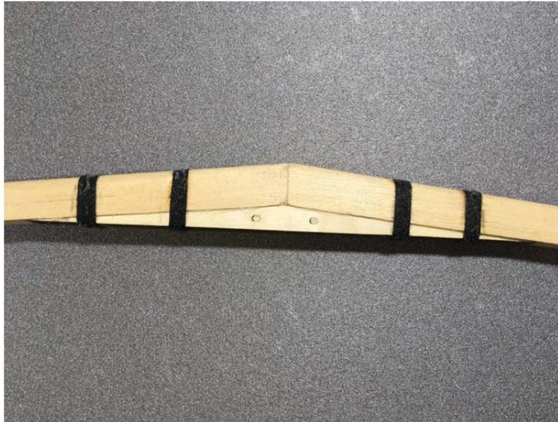
Собираем на клей переднюю кромку, центральную часть и мотораму.
