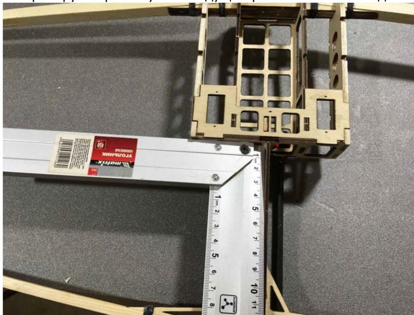
Сажаем места соединений на клей и зажимаем прищепками.
